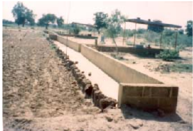
Dispositif expérimental d'étude du ruissellement et de l'érosion du sol. Champ aménagé de cordons pierreux
